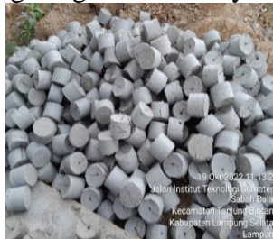
Gambar 3.5. Beton Decking Sumber : Dokumentasi Lapangan
