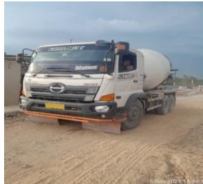
Gambar 3.19. Truck Mixer Sumber : Dokumentasi Lapangan
