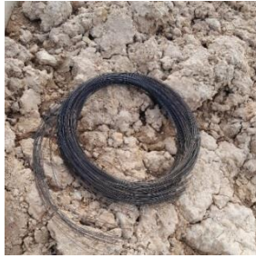
Gambar 3.3. Kawat Bendrat Sumber : Dokumentasi Lapangan
