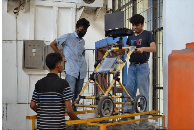
Gambar 13. Proses scanning data menggunakan Geoscanner.
