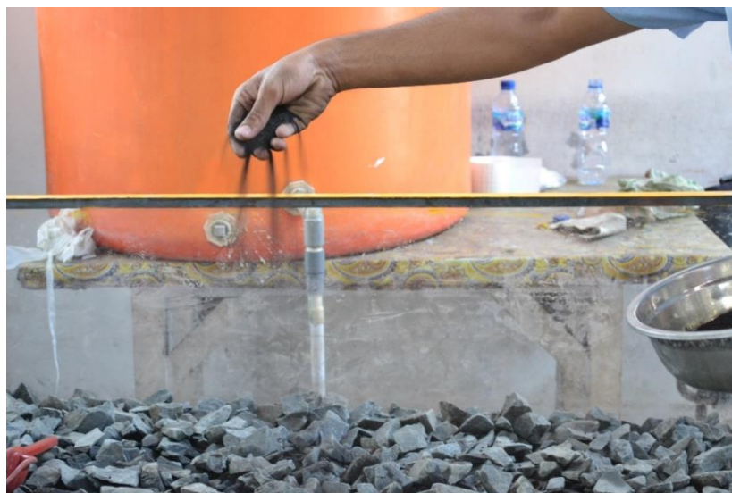
Gambar 16. Ballast dalam kondisi fouled .
