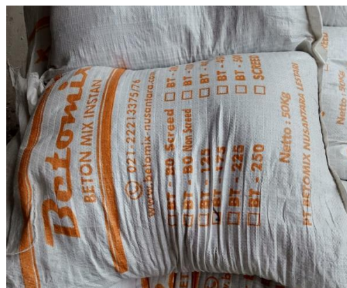
Gambar 3. 9 Beton Mix Instan (Sumber : Dokumentasi Penulis)
