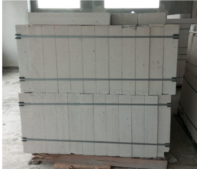
Gambar 3. 1 Bata Ringan ( Habel ) (Sumber : Dokumentasi Penulis)
