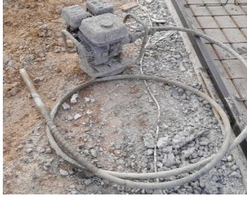
Gambar 3.21 Concrete Vibrator (Sumber : Dokumentasi Penulis, 2022)
