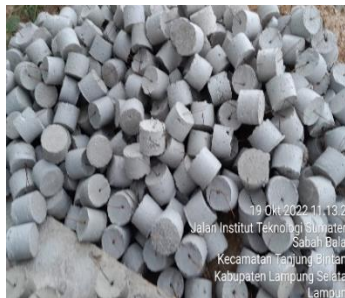
Gambar 3.10 Beton Decking (Sumber : Dokumentasi Penulis, 2022)
