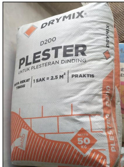
Gambar 3.22 Base Plester (Sumber : Dokumentasi Penulis,2022)
