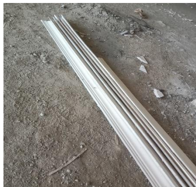
Gambar 3.25 : crown moulding gypsum Sumber : Foto Lapangan
