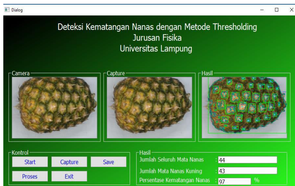
Gambar 2.2 Tampilan pada GUI hasil deteksi kematangan nanas menggunakan metode thresholding (Yanti et al. , 2022)
