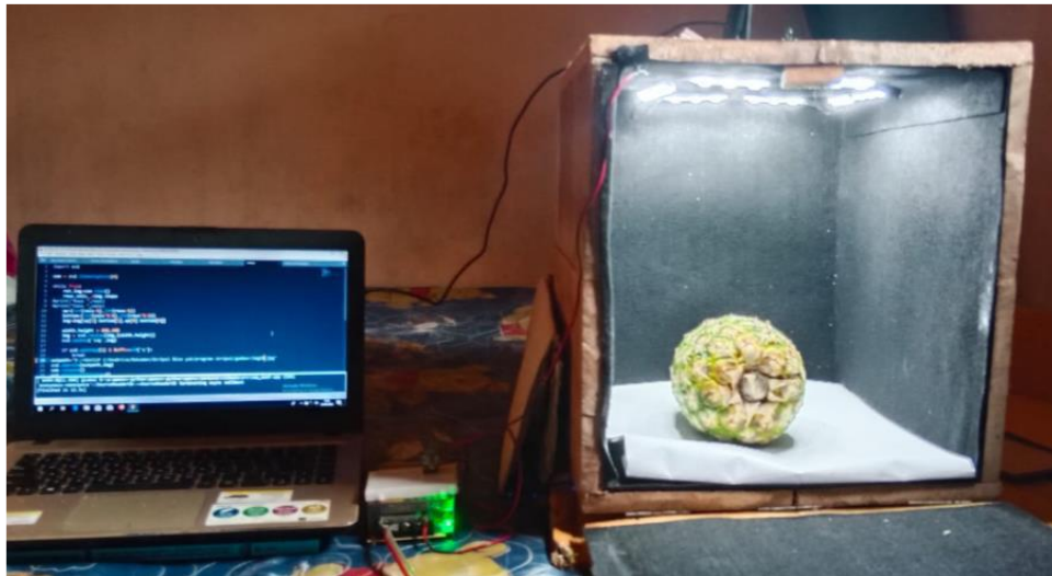
Gambar 2.1 Alat deteksi kematangan buah nanas menggunakan metode thresholding (Yanti et al. , 2021)
