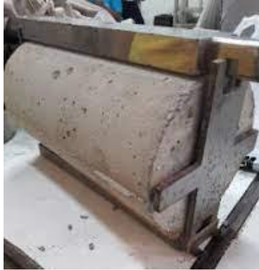
Gambar 3.2. Posisi sampel saat pengujian kuat tarik belah.
