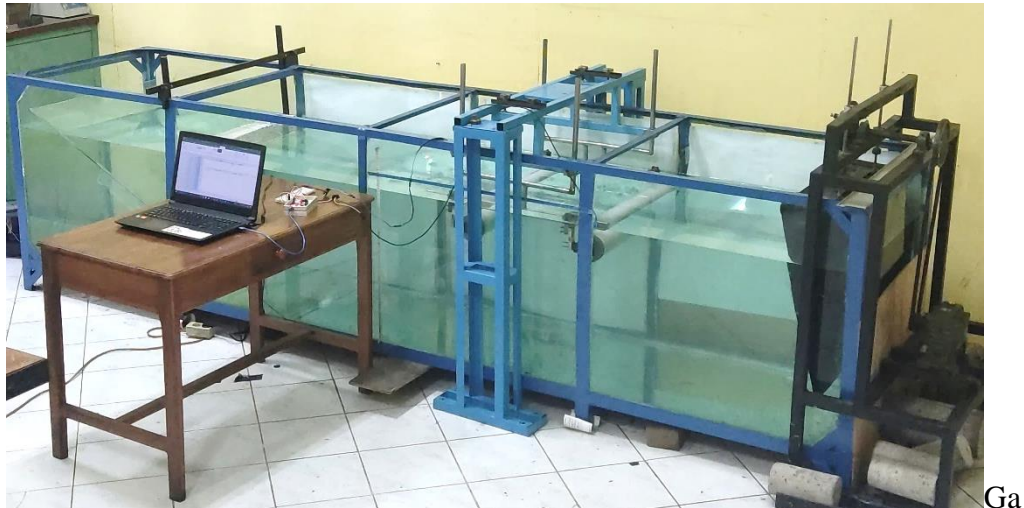
mbar 3.3 Gambar peralatan kolam ombak yang dimiliki Laboratorium Mekanika Struktur, Teknik Mesin, Universitas Lampung
