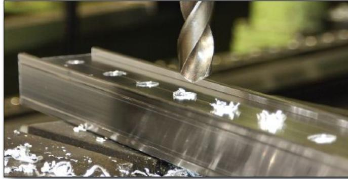
Gambar 2.1 Mekanisme kerja proses pengeboran magnesium
