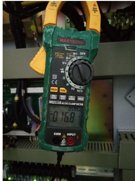
Gambar 3.13 Pengukuran arus listrik dengan clamp meter digital
