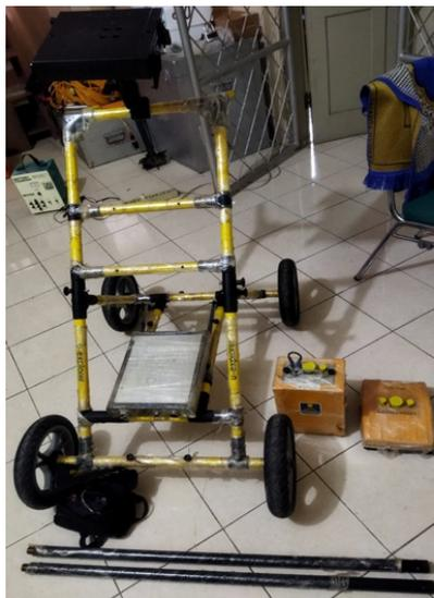
Gambar 3. 4 GPR dengan antenna berfrekuensi 1 GHz
