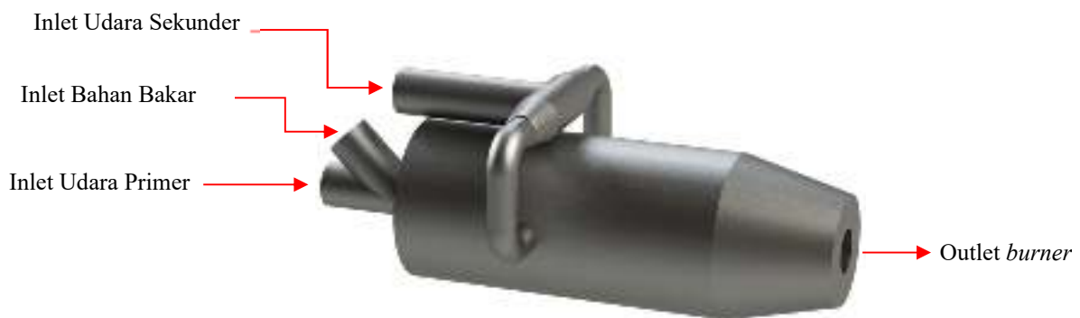
Gambar 3.2 Geometri 3D pulverized bed yang akan digunakan pada simulasi co-firing
