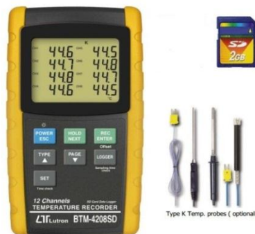
Gambar 3.2. Data logger dan Thermocouple
