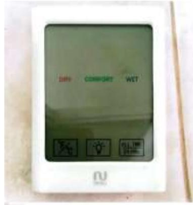
**Gambar 2. 1** *Thermohygrometer Notale*
