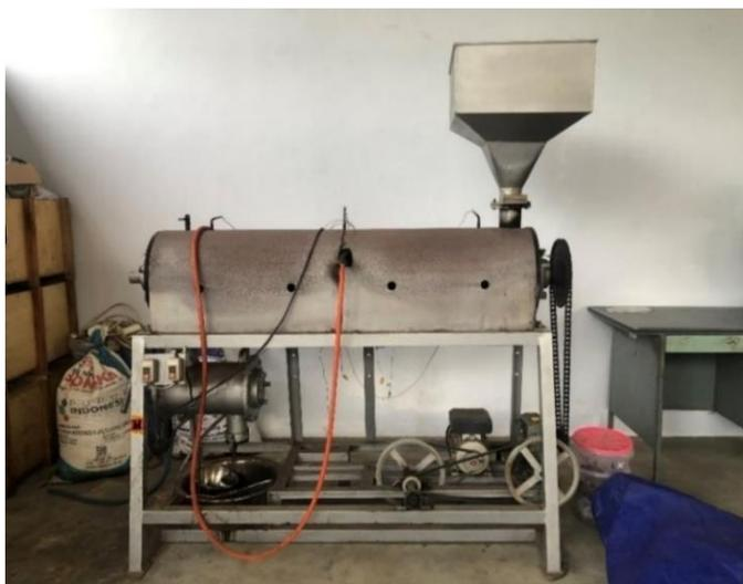
Gambar 3.1. Reaktor Torefaksi Kontinu Tipe Tubular dengan Sistem pemanas *Oil Jacket* dari LPG.
