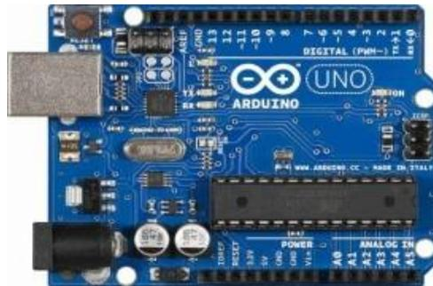
Gambar 2.1 *Arduino Uno* tampak atas
