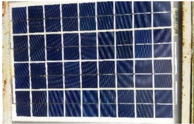
Gambar 2.8 Panel surya jenis polikristal (Dok: Pribadi)
