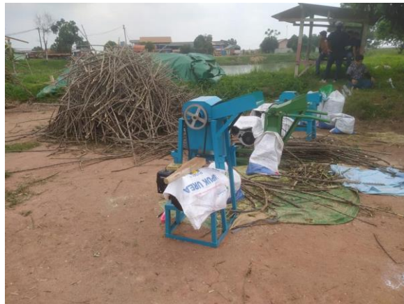
Gambar 5. Pencacahan batang ubikayu sebagai sumber K organik dengan alat Rabakong
