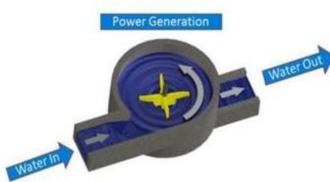
Gambar 2.3. Skema pembangkit listrik menggunakan turbin vortex (Power, 2016)
