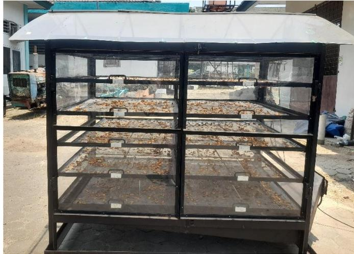
Gambar 2. Alat pengering tipe rak
