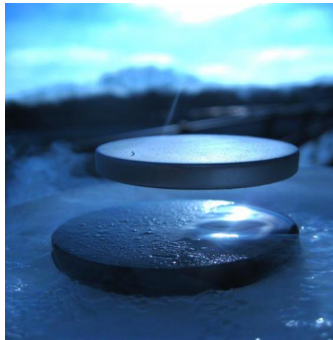
Gambar 3. Efek Meissner pada superkonduktor yang memberikan gejala penolakan medan magnet luar (Wanibesak, 2011).
