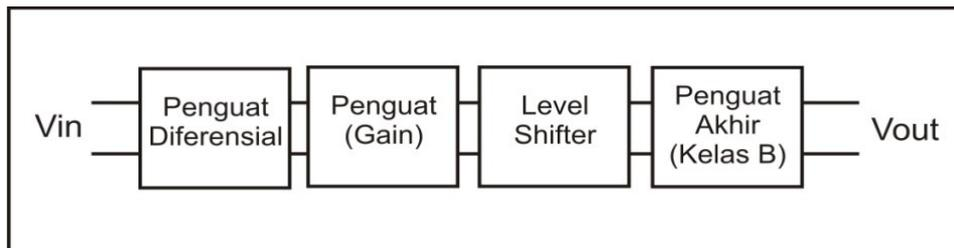
Gambar 2.5. Diagram blok op-amp
