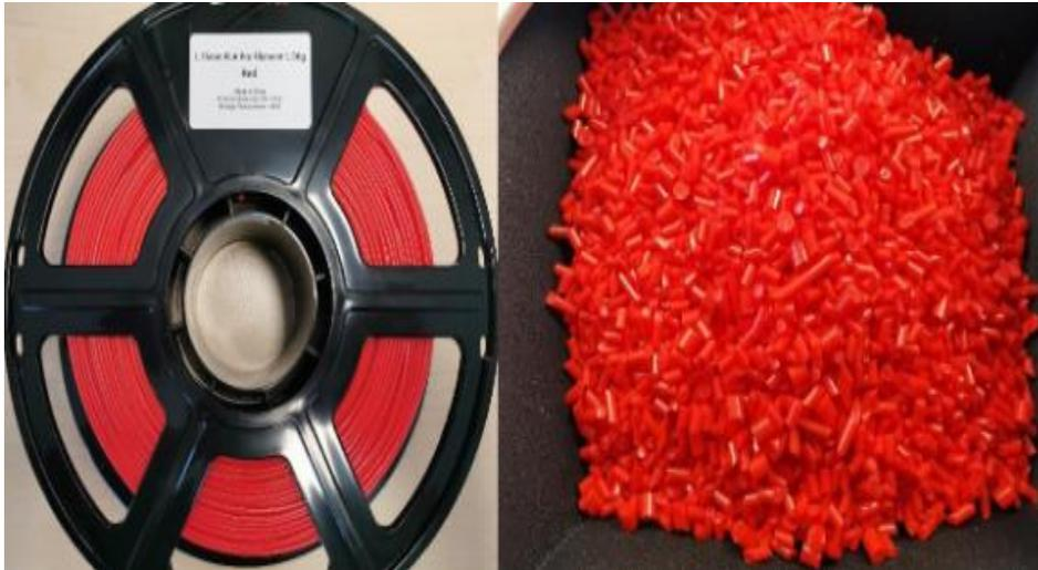
Gambar 2.6 Bahan PLA dalam bentuk (a) filamen dan (b) pelet.
