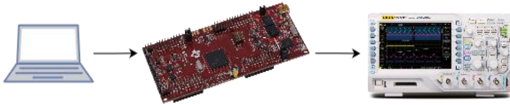
Gambar 3. 23 Skema Pengujian Keluaran Sinyal PWM
