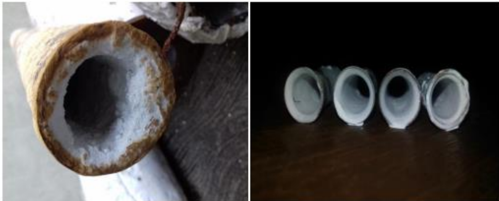
Gambar 1. Endapan kerak pada pipa (Raharjo S., 2016)
