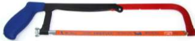
Gambar 21. Gergaji tangan untuk memotong papan acrylic
