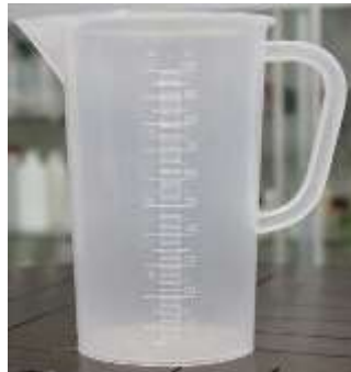
Gambar 22. Gelas ukur untuk menakar jumlah resin dan hardener 1:1.
