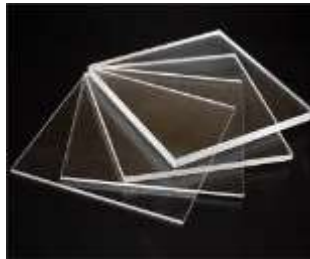
Gambar 15. Papan acrylic 3mm untuk membuat cetakan spesimen
