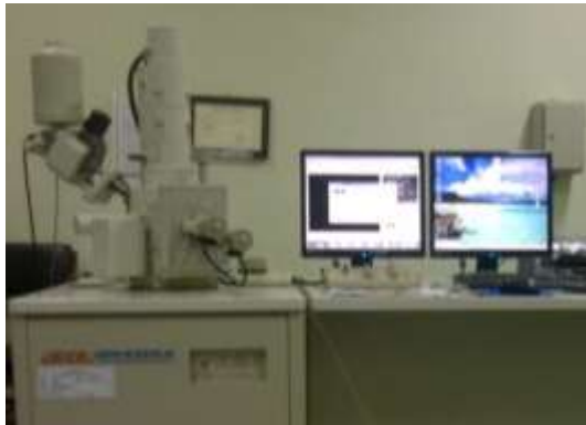
Gambar 18. Alat uji SEM di PPPGL Bandung
