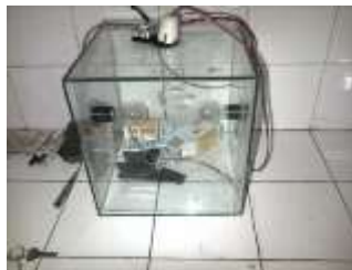
Gambar 16. Inkubator untuk proses curing komposit.
