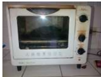
Gambar 19. Tungku pemanas untuk menghilangkan kadar air serat ijuk
