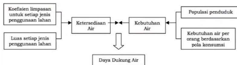
**Gambar 2.4** Diagram Penentuan Daya Dukung Air
