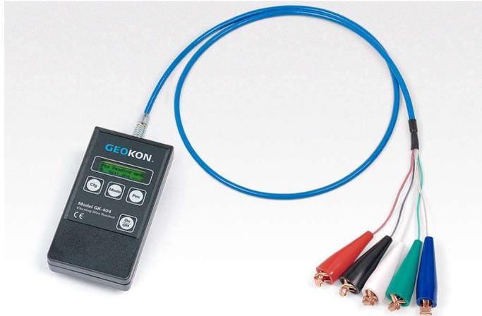
Gambar 3.5. *Handheld Readout (VW) Model GK-404*
