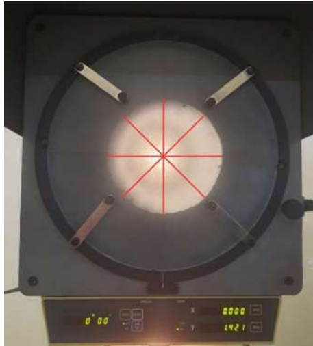
Gambar 3.9. Proses penarikan garis pada microscop profil projector
