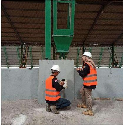
**Gambar 13.** Pengujian *Hammer Test*.
