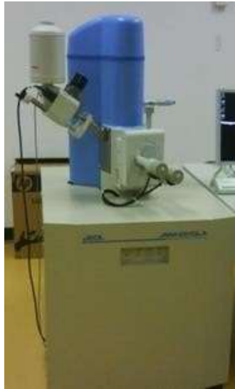
Gambar 2.5. Alat karakterisasi SEM (Laboratorium Sentral dan Inovasi Universitas Lampung) (Dokumen pribadi).
