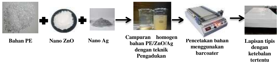
Gambar 3.2 Skema pembuatan lapisan tipis PE/ZnO/Ag.
