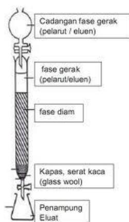
**Gambar 6.** Skema Kromatografi Kolom
