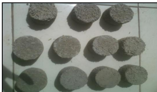
Gambar 4.4. Hasil komposit batako beton ringan dari proses pemanasan yang siap untuk dikarakterisasi.
