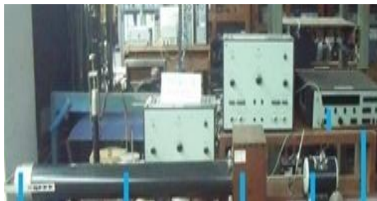
Gambar 4.10. Alat pengujian spesimen peredam bunyi.
