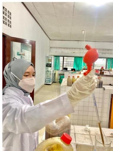
Gambar 12. Pencampuran sampel limbah cair dengan aquadest
