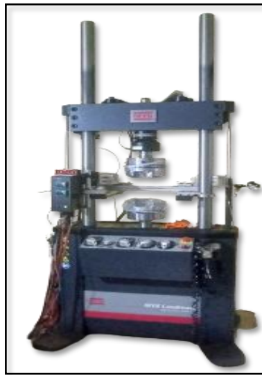
Gambar 2.4 Mesin Uji Tarik merk MTS Landmark (dokumen pribadi)
