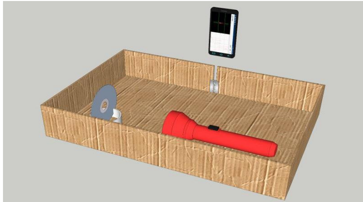
Gambar 2. Desain Alat Spektrofotometer Sederhana
