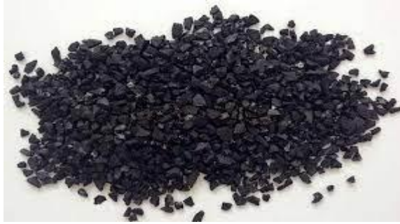
Gambar 2.8 Karbon aktif bentuk granular (Smisek & Cerny, 1970)
