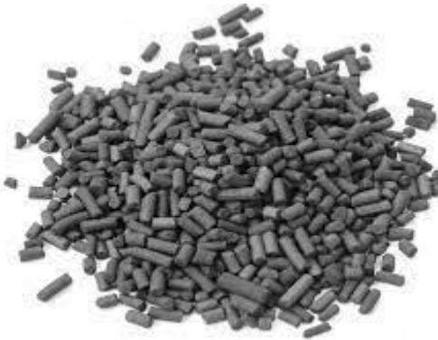
Gambar 2.9 Karbon aktif bentuk pellet (Efiyanti et al. , 2019)
