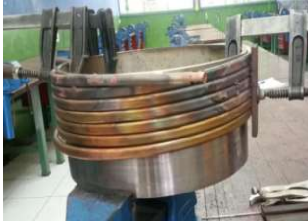
Gambar 2.5 Pelilitan koil untuk sistem pendinginan (Sumber: Subarkah, dkk. 2020)
