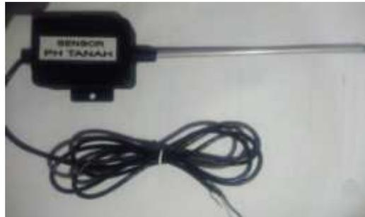
**Gambar 2.3** Sensor pH Tanah
