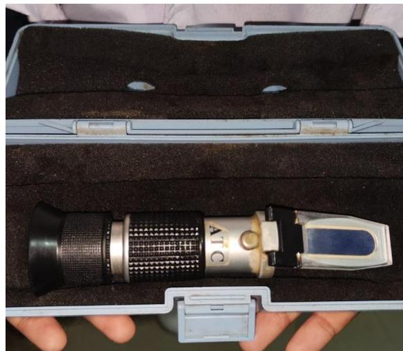
**Gambar 2.3** Refraktometer *Brix*.
