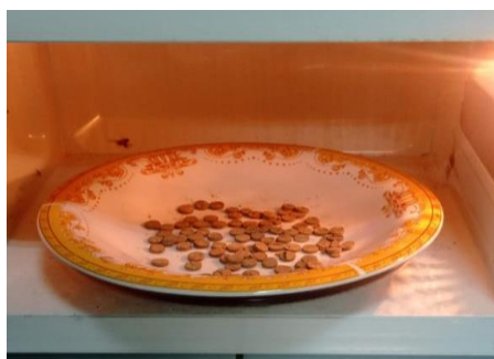
Gambar 25. Aktivasi pelet bentonite
