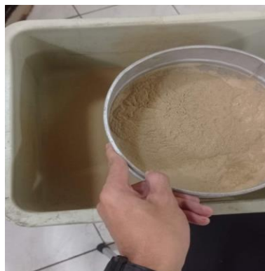
Gambar 22. Mengayak bentonit dengan ayakan 100 mesh
