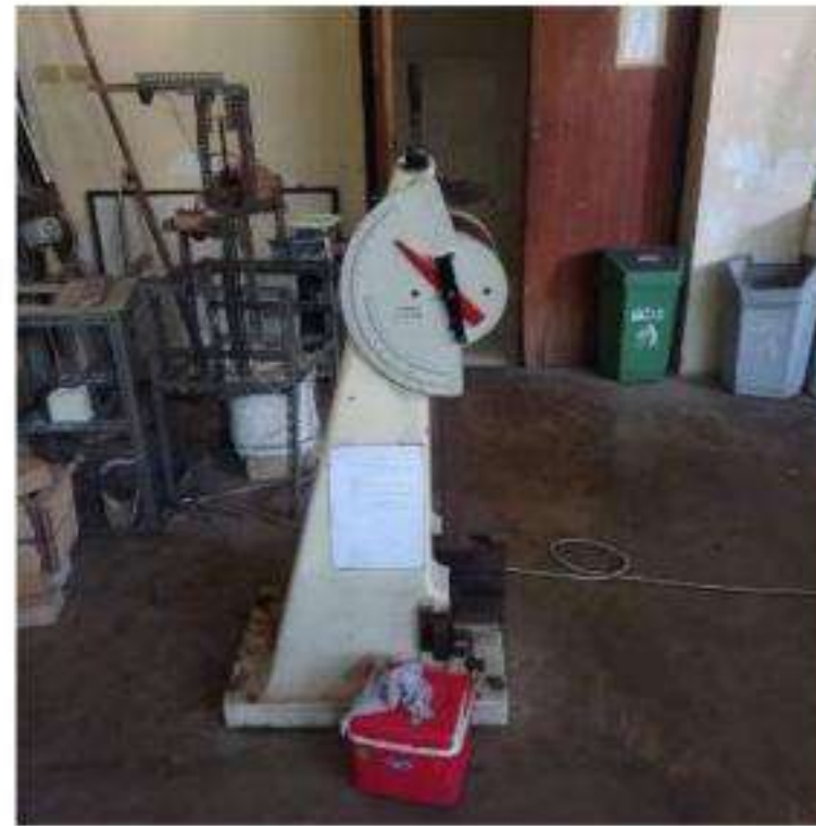
Gambar 10. Mesin Uji Impact ( Impact testing machine ).
