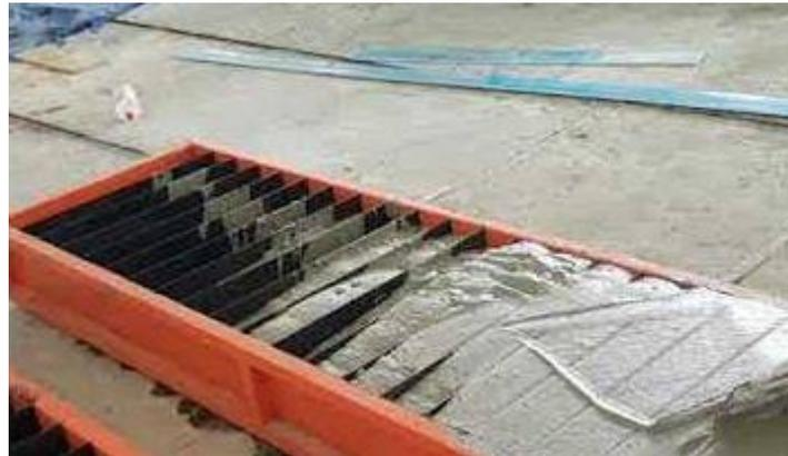
Gambar 2. 2. Pembuatan Bata Ringan AAC
