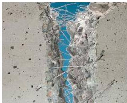
Gambar 2.5. Mekanisme Kerja Serat
