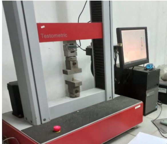
Gambar 8. Pengujian kuat tekan menggunakan universal testing machine (UTM)
