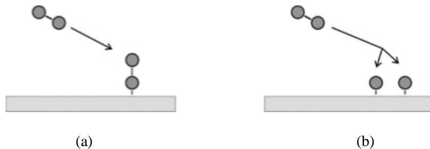
Gambar 2.2 Penyerapan (a) Fisika, (b) Kimia gas pada permukaan
