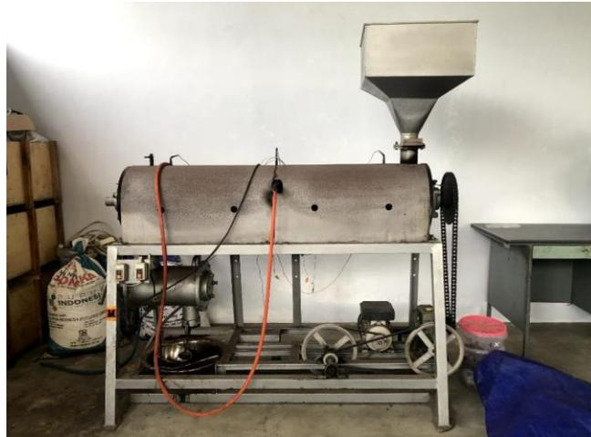
Gambar 3.1 Reaktor torefaksi kontinu tipe turbular
