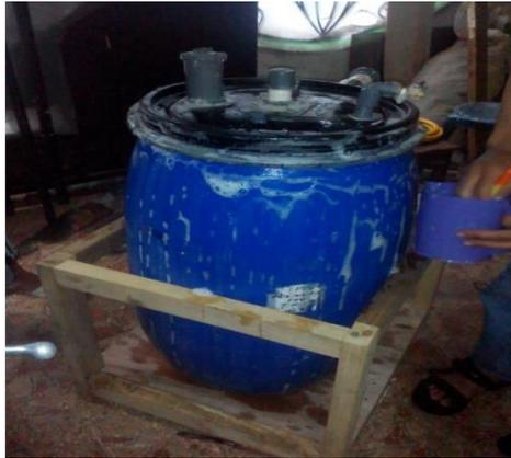
Gambar 7. Reaktor biogas hasil pengembangan Basri dkk. (2019).
