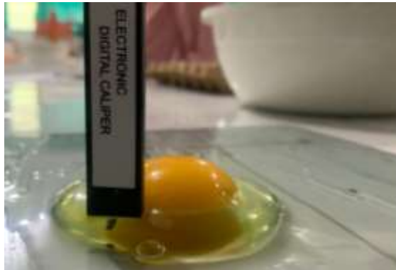
Gambar 6. Pengukuran tinggi albumen kental
