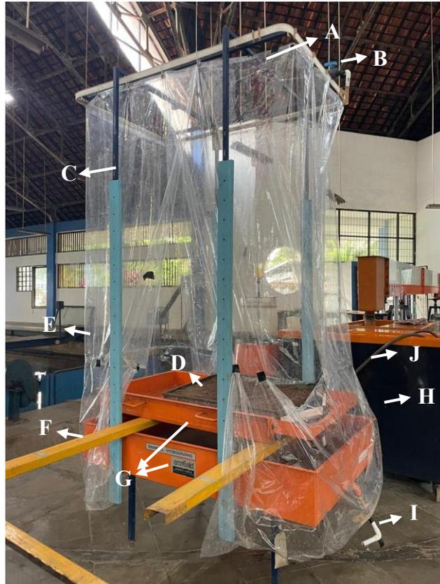
Gambar 3. Seperangkat alat *rainfall simulator*.
