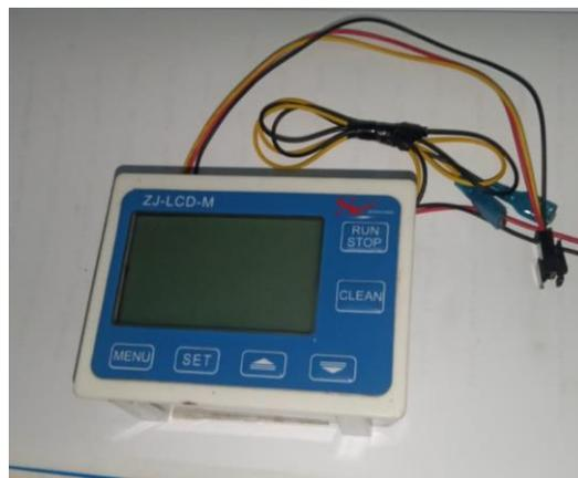
Gambar 3.4 *Water flow meter*Tabel 3.4 Spesifikasi *Water Flow Meter*
